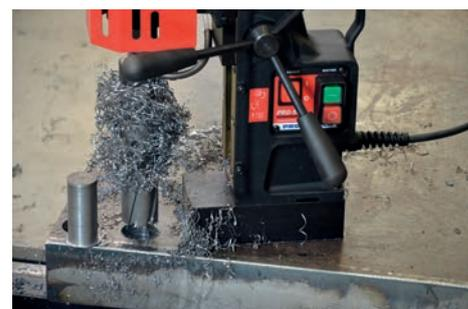
Capacidad de fresado de hasta 45 mm
