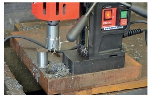
Capacidad de fresado de hasta 40 mm
