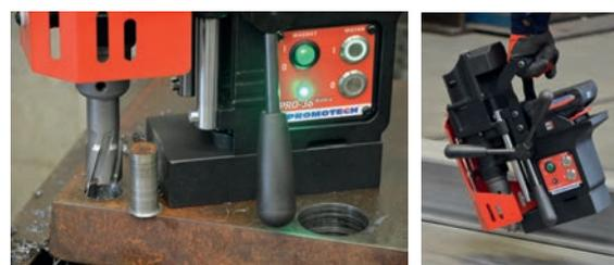
Capacidad de fresado de hasta 36 mm
