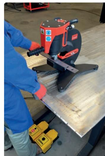
Función de manos libres mediante control de la máquina con pedal en la configuración de banco de trabajo.
