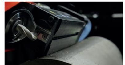
Base magnética prismática en forma de V para la perforación de tubos
