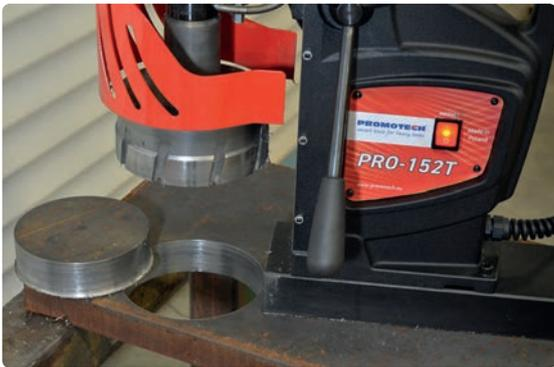
Capacidad de fresado de hasta 150 mm
