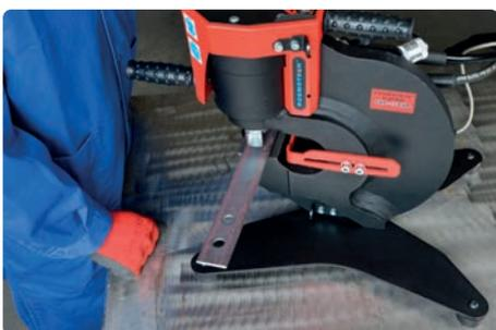
No se necesitan equilibradores ni grúa para mantener la punzonadora en posición. Un operario puede operar la punzonadora utilizando sus botones, o el pedal de pie.
