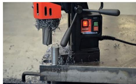
Capacidad de fresado de hasta 45 mm
