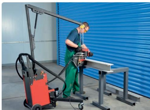
Brazo grúa y 2 soportes con ruedas que permiten una manipulación sencilla de la punzonadora y del equipo hidráulico como un único conjunto
