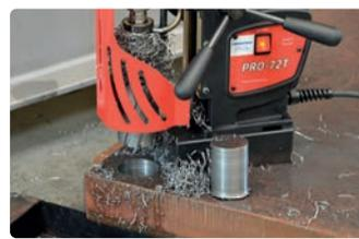
Capacidad de fresado de hasta 70 mm
