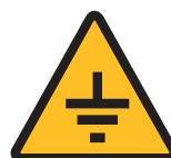
Ref. 1011AD10 TOMA DE TIERRA
